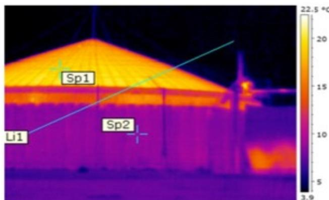
Déperditions thermiques sur un digesteur voie liquide
